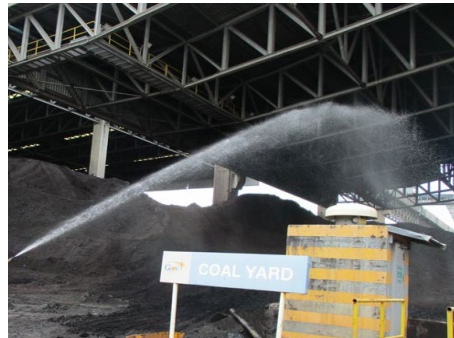
ภาพที่ 2-4 การฉีดพ่นน้ำบนกองถ่านหิน
