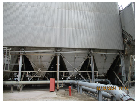
ภาพที่ 2-8 ระบบดักจับฝุ่นแบบถุงกรองอากาศเสีย (Baghouse filter)
